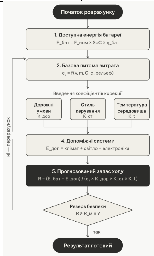
Рисунок 2.4 – Блок-схема розрахунку прогнозованого запасу ходу
