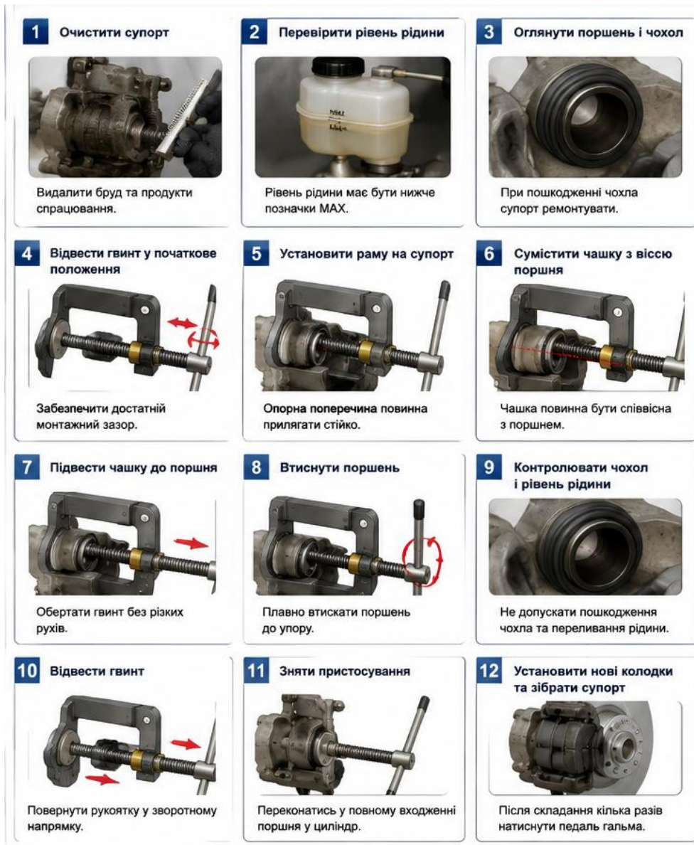
Рисунок 3.2 – Послідовність використання пристосування.
