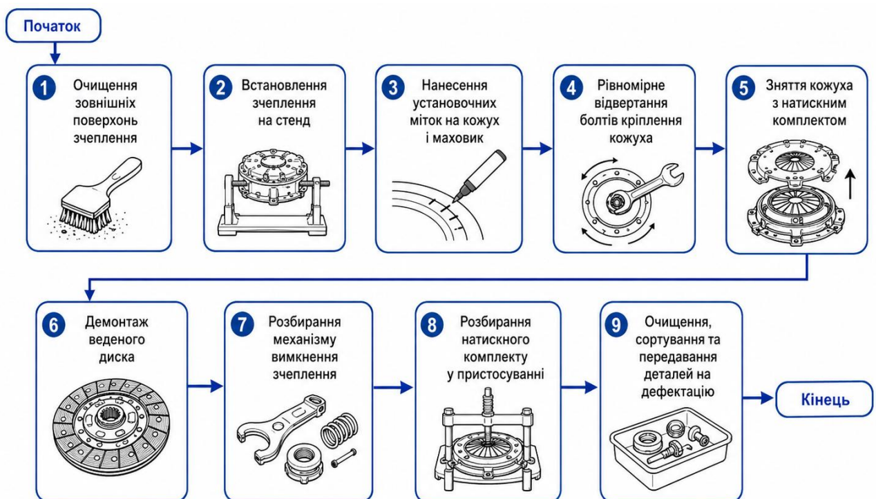
Рисунок 2.1 – Послідовність розбирання зчеплення двигуна ЯМЗ-236.
