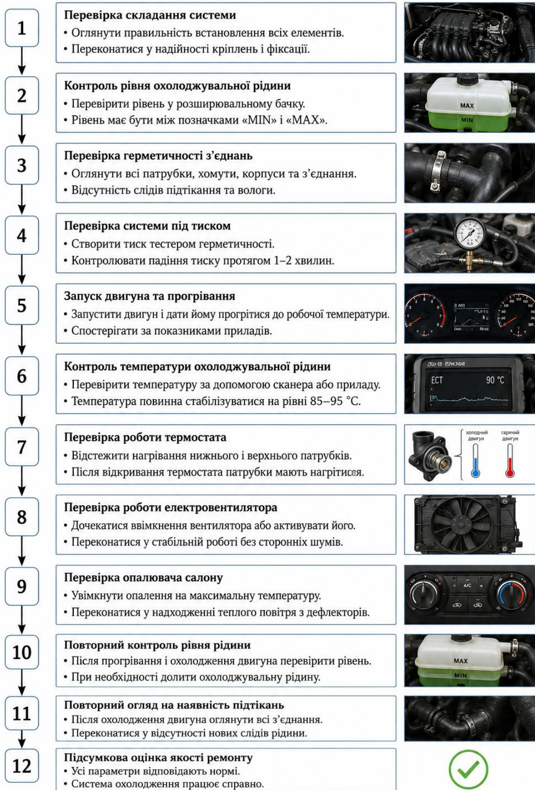
Рисунок 2.6 – Послідовність контролю якості ремонту системи охолодження двигуна HR16DE
