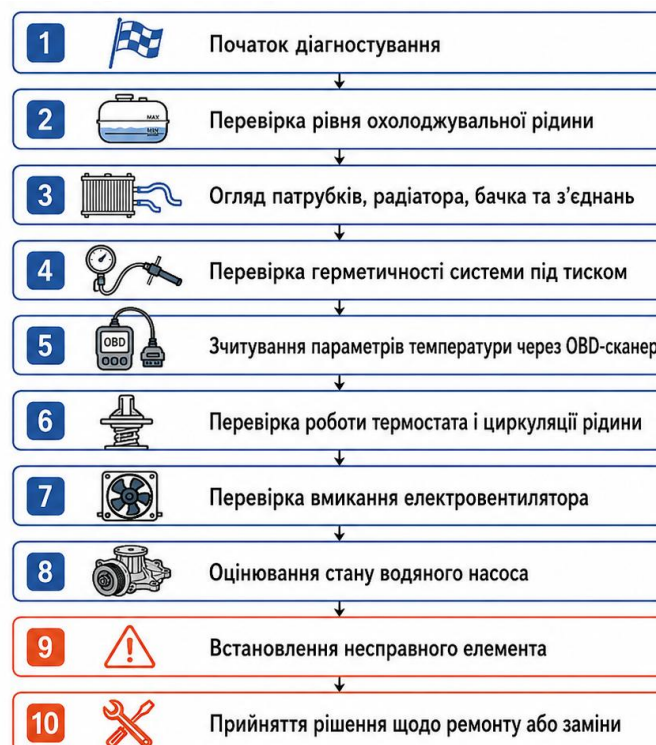
Рисунок 2.1 – Алгоритм діагностування системи охолодження двигуна HR16DE.
