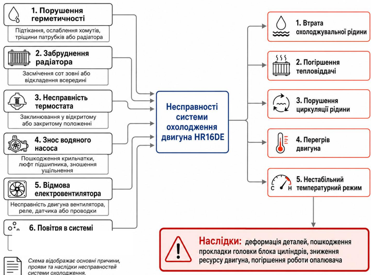
Рисунок 1.2 – Причинно-наслідкова схема виникнення несправностей системи охолодження двигуна HR16DE.
