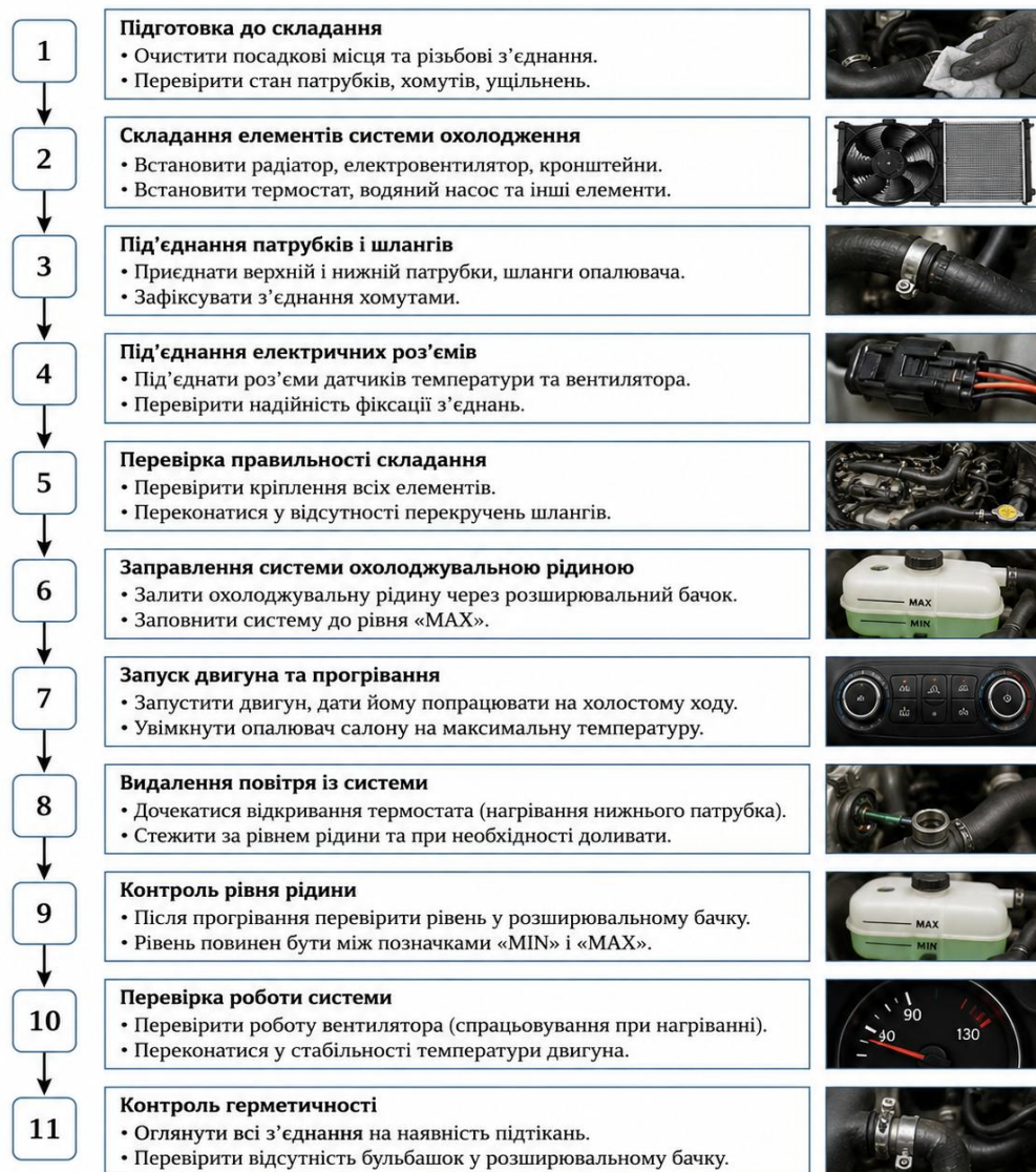
Рисунок 2.5 – Послідовність складання, заправлення та видалення повітря із системи охолодження двигуна HR16DE.
