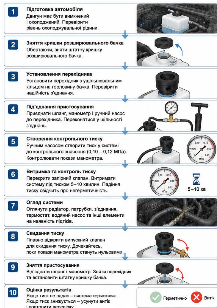
Рисунок 3.3 – Послідовність використання пристосування для перевірки герметичності системи охолодження.
