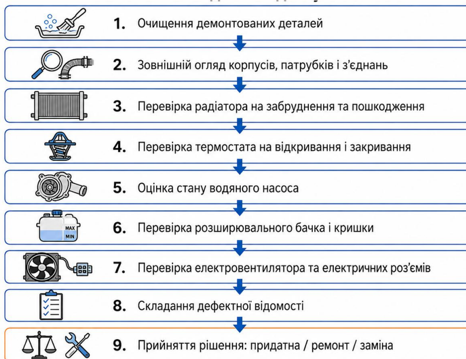
Рисунок 2.3 – Послідовність дефектування деталей системи охолодження двигуна HR16DE.
