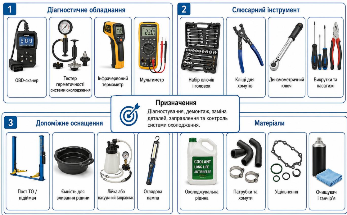
Рисунок 2.7 – Комплект обладнання та інструменту для ремонту системи охолодження двигуна HR16DE.
