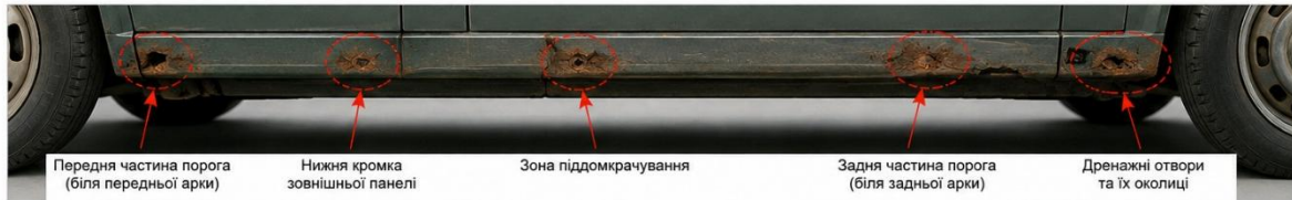
Рисунок 1.3 – Типові зони корозійного пошкодження порога Volkswagen Transporter T4.
