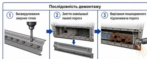
Рисунок 2.4 – Демонтаж зовнішньої панелі та пошкодженого підсилювача порога:
