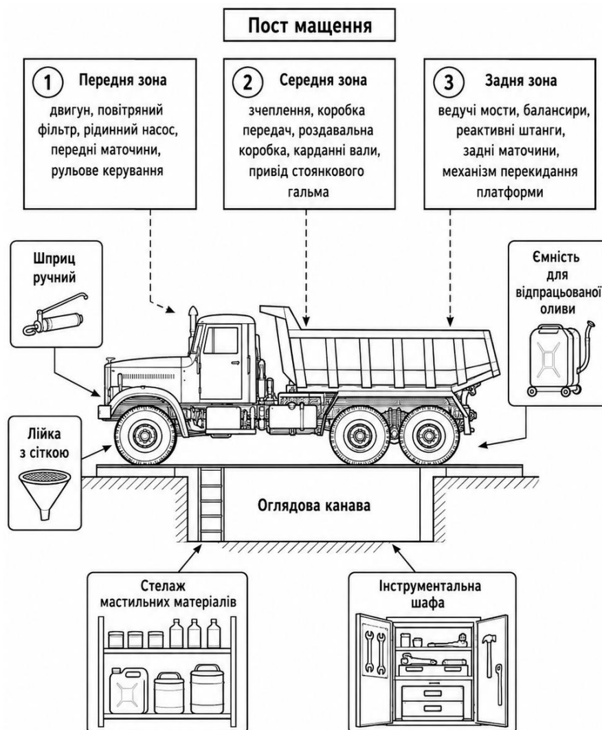
Рисунок 2.3 – Схема організації поста мащення автомобіля КрАЗ-256Б1.
