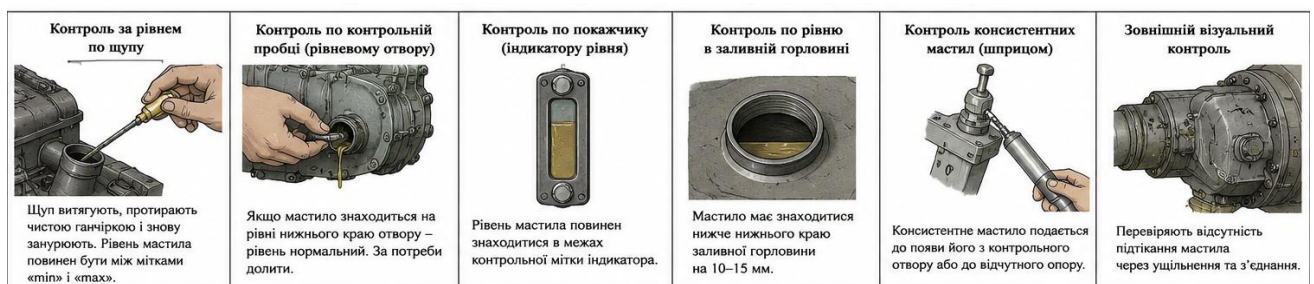
Рисунок 1.2 – Способи контролю заповнення вузлів мастильними матеріалами.
