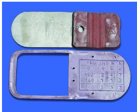
Рисунок 3.5 – Пластинчастий щуп для контролю теплового зазору в приводі клапанів.
