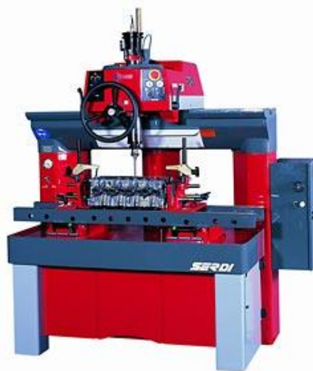
Рисунок 2.2 – Універсальний верстат для відновлення ГБЦ «SERDI 4,5 Power» (Італія).
