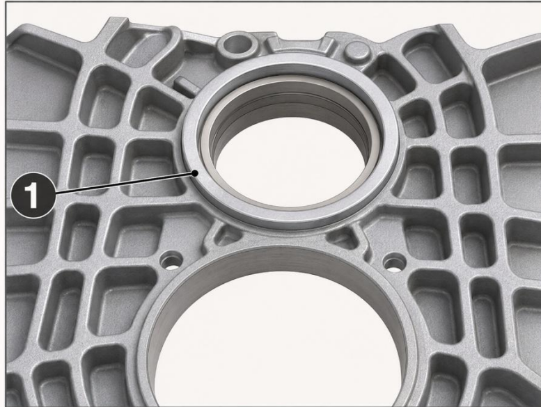
Рисунок 3.11 – Установлення регулювального кільця 1 проміжного вала
