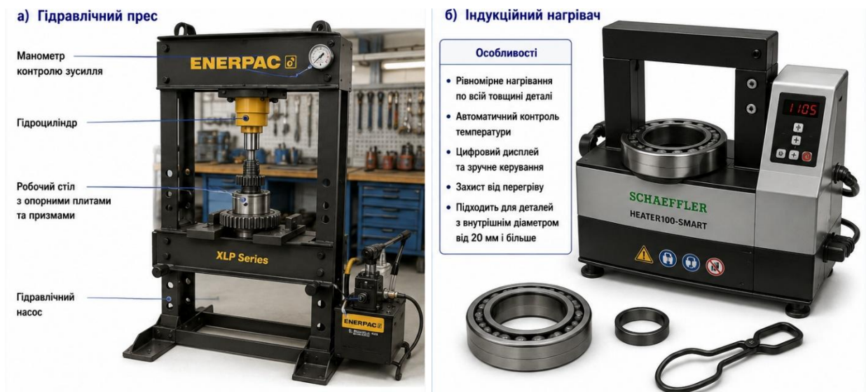
Рисунок 2.18 – Обладнання для демонтажу та монтажу деталей валів: а – гідравлічний прес; б – індукційний нагрівач.
