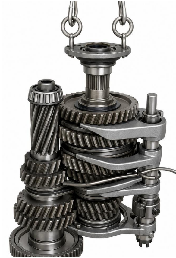
Рисунок 2.12 – З'єднання валів перед їх установленням у картер.
