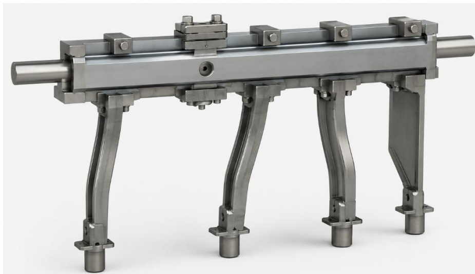
Рисунок 2.9 – Розріз вилок приводу перемикання передач.
