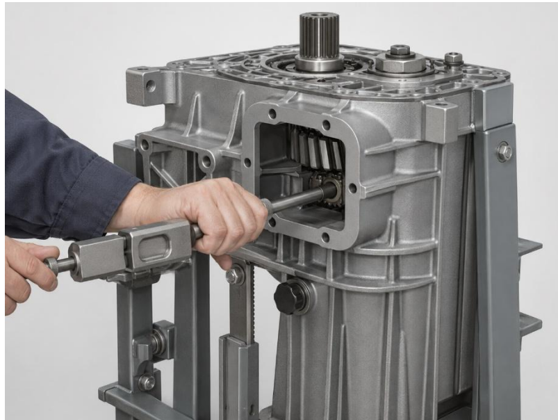
Рисунок 2.4 – Запресовування розвідного шплінта до упору стрижнем відповідного діаметра.
