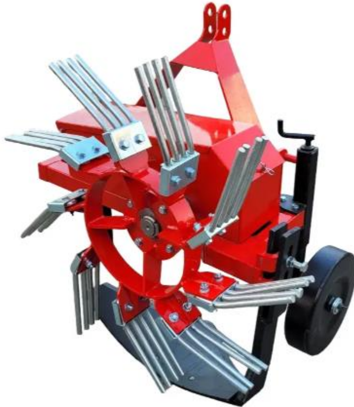
Рисунок 1.2 – Картоплекопачі роторного типу Wirax [4]
