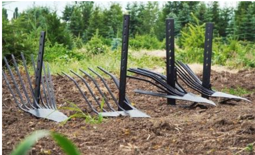
Рисунок 1.1 – Найпростіші підкопуючі лапи [5]
