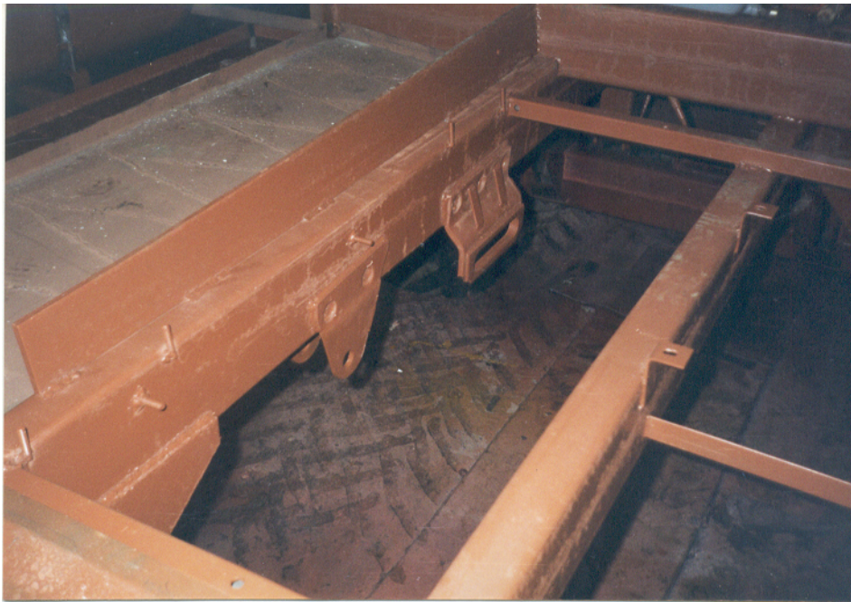
Рисунок 1.5 – Центральний брус, підсилений ребром жорсткості
