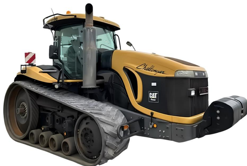
Рисунок 1.1 – Трактор гусеничний Challenger – МТ 865
