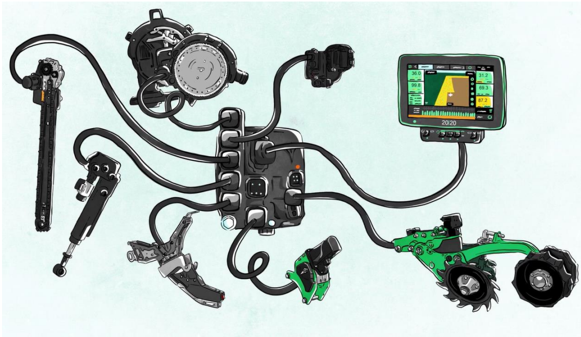
Рисунок 3.8 – Бортовий інформаційно – керуючий термінал системи точного висіву Precision Planting 20/20 SeedSense
