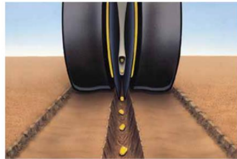
Рисунок 3.2 – Функціонально – технологічна схема та критичні етапи робочого процесу посівної секції просапного комплексу
