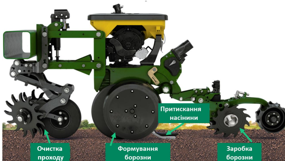
Рисунок 3.3 – Технологічна схема та послідовність виконання операцій модернізованою висівною секцією посівного комплексу
