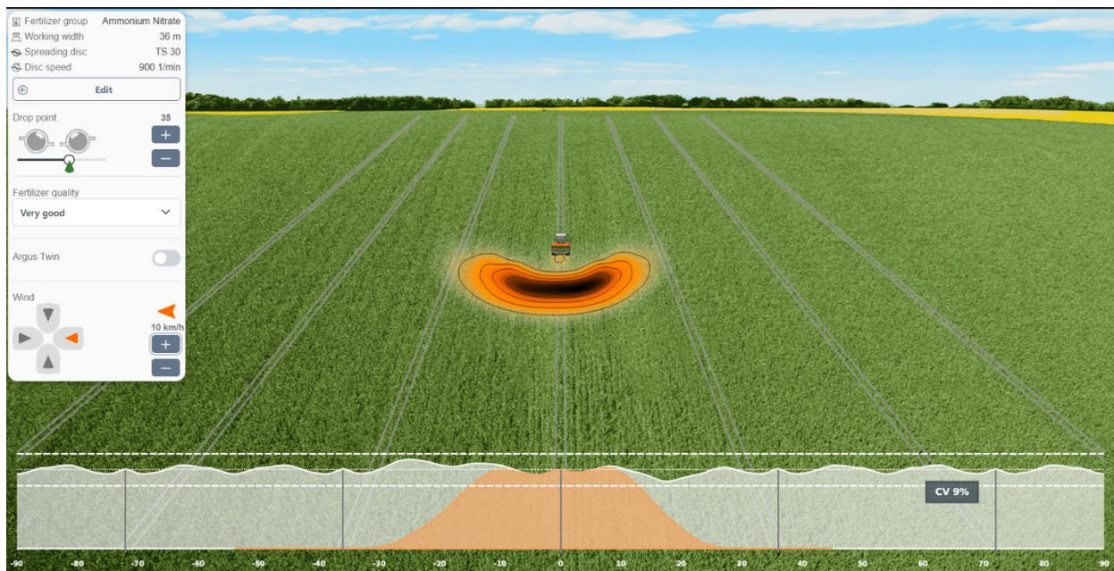
Рисунок 2.3 - Внесення продукту без використання технології Argus Twin зі швидкістю східного вітру 10 км/год.
