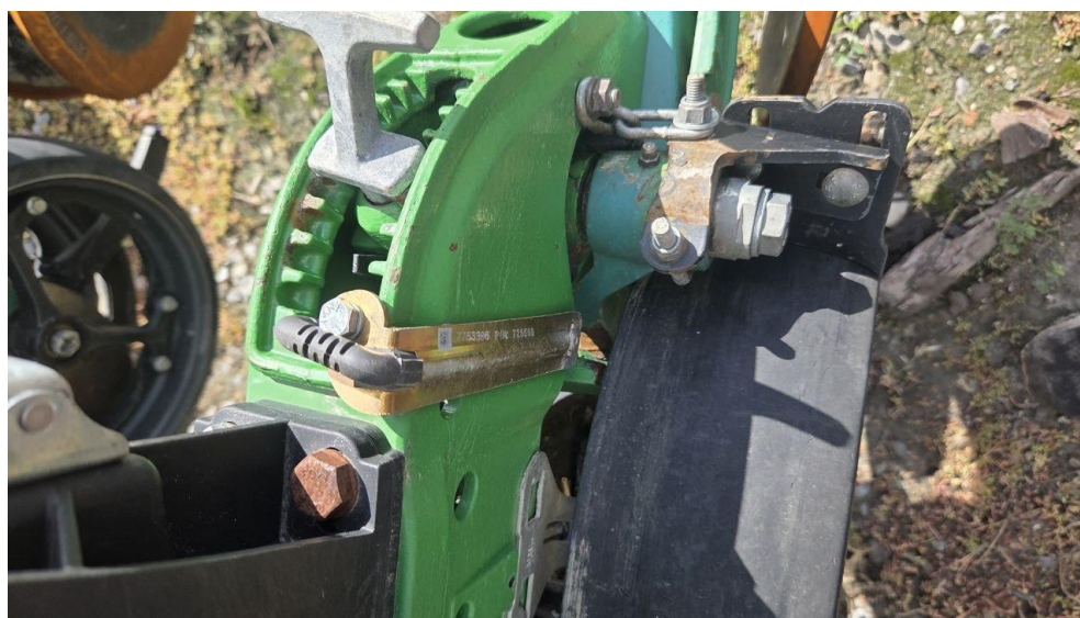
Рисунок 3.2 Тензодатчик системи прикочування FurrowForce
