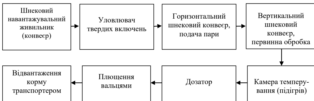
Рисунок 3.4 – Технологічні операції модернізованої плющильної машини.
