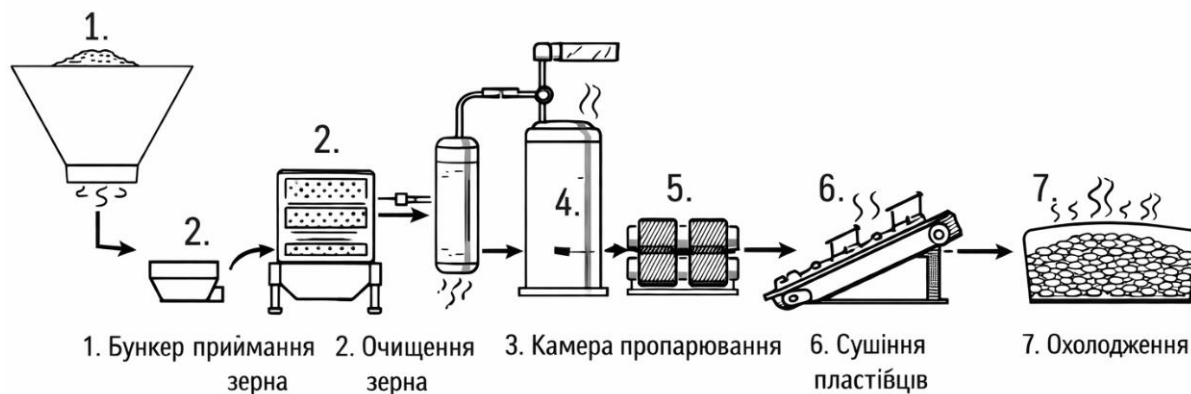
Рисунок 2.4 – Технологічна схема пропарювання з плющенням зерна (парове плющення)
