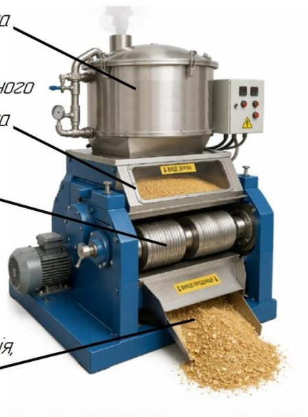
Рисунок 1.3. – Технологічна схема подрібнення фуражного зерна методом плющення
