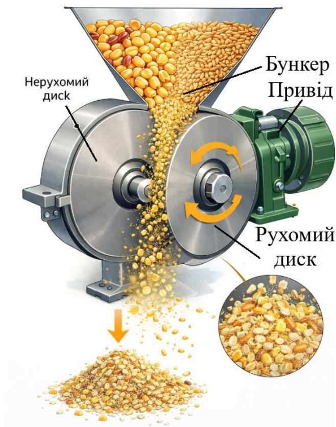
Рисунок 1.5 – Технологічна схема подрібнення фуражного зерна методом стирання
