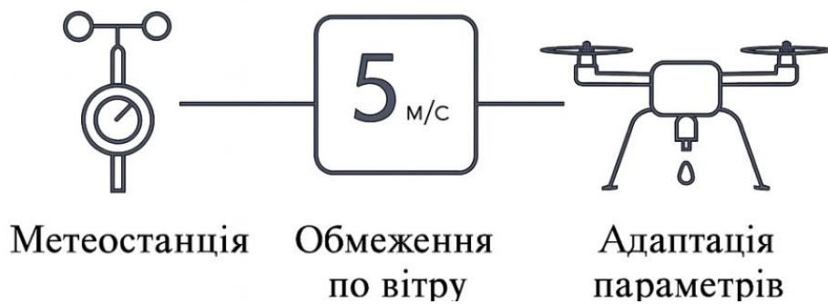
Рисунок 1.10 – Принципова схема антидріфтного обприскування.
