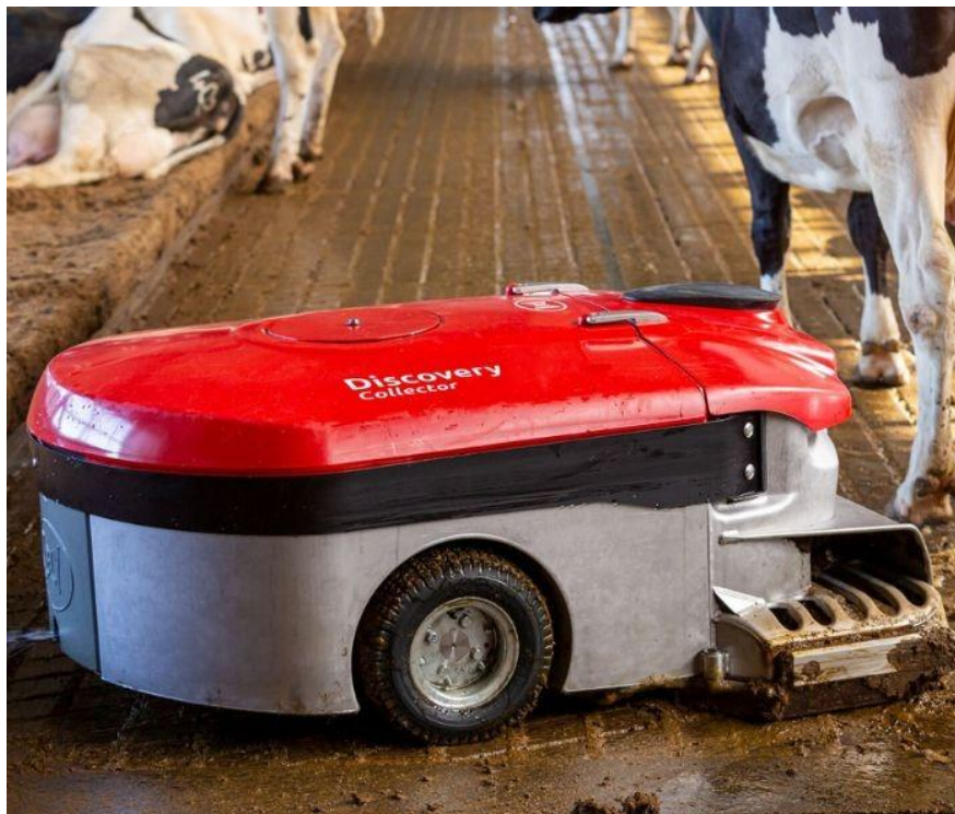
Рисунок 1.3 – Робот-скрепер при виконанні прибирання гною
