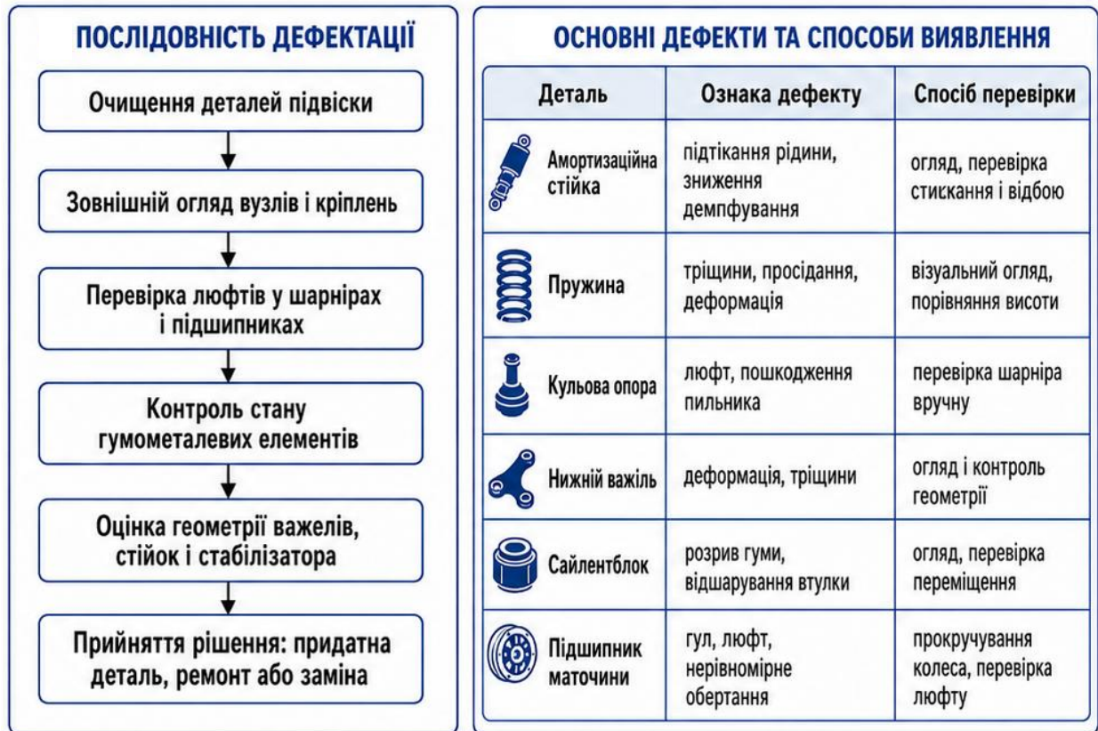
Рисунок 1.3 – Послідовність проведення дефектації деталей передньої підвіски
