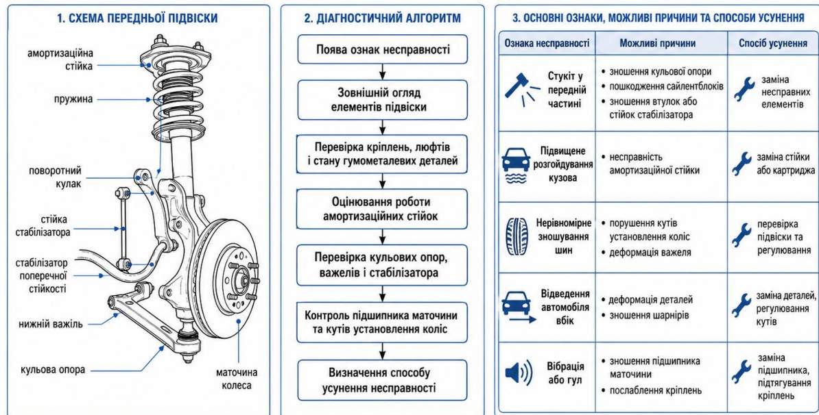
Рисунок 1.2 – Схема визначення несправностей передньої підвіски автомобіля Богдан 2110.
