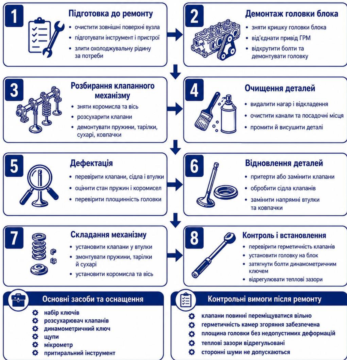
Рисунок 2.2 – Послідовність ремонту клапанного механізму головки блока циліндрів.
