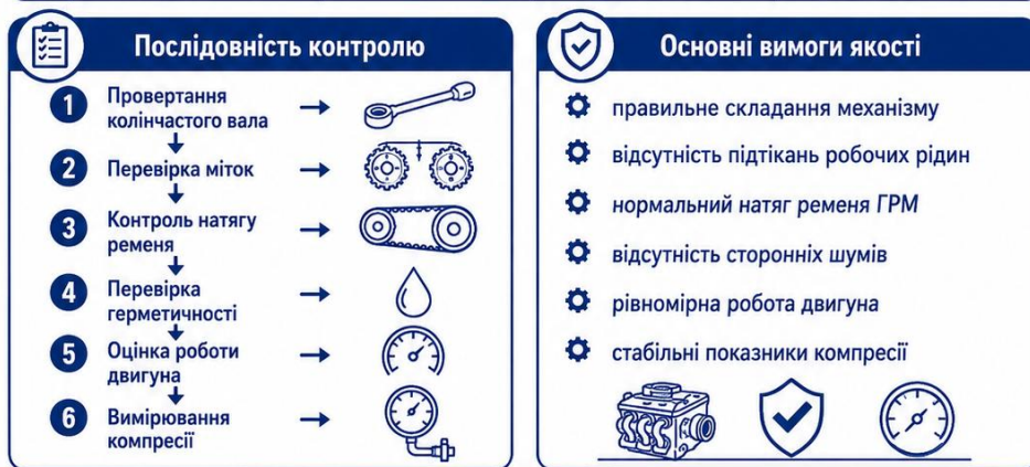
Рисунок 2.4 – Контрольні операції після ремонту.
