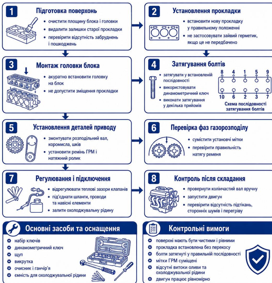
Рисунок 2.3 – Технологічна карта установлення головки блока циліндрів на двигун.
