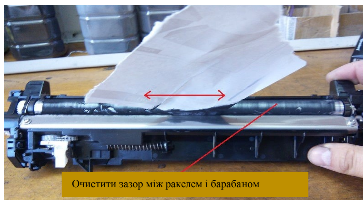
Рисунок 2.15 – Видалення сміття з простору між барабаном та шваброю
