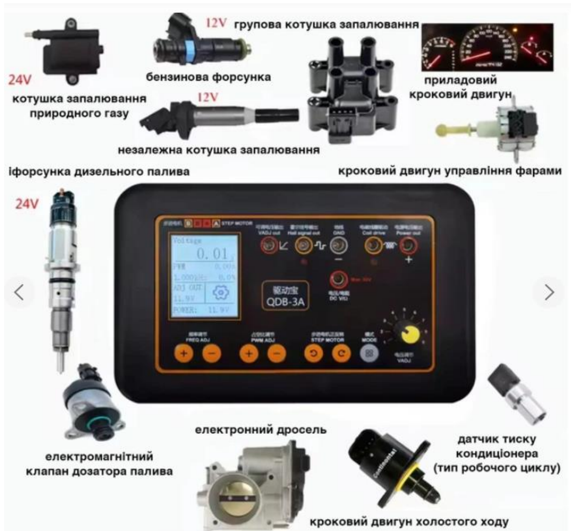
Рисунок 3.2 – Елементи, що входять до комплекту автомобільного тестера перевірки котушки запалювання [33]
