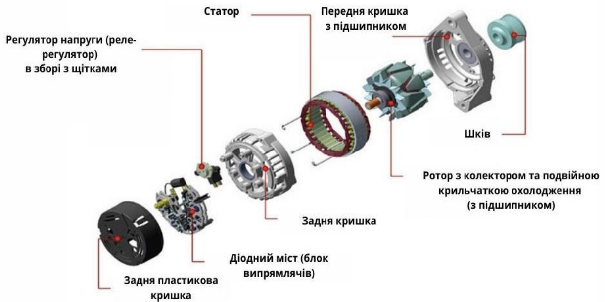
Рисунок 2.1 – Будова генератора
