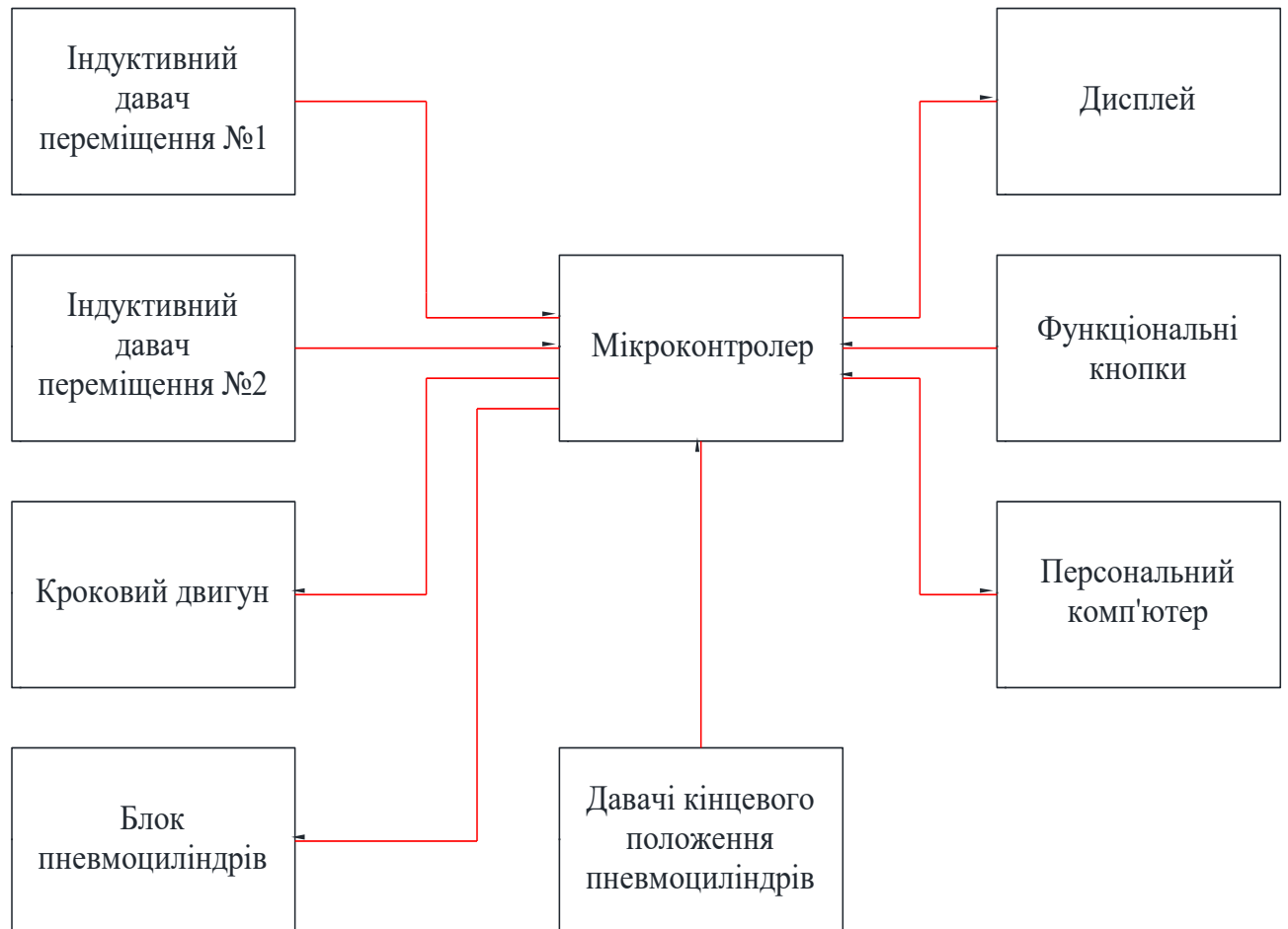
Рисунок 3.4 – Функціональна схема приладу для вимірювання відхилення від форми циліндричних поверхонь
