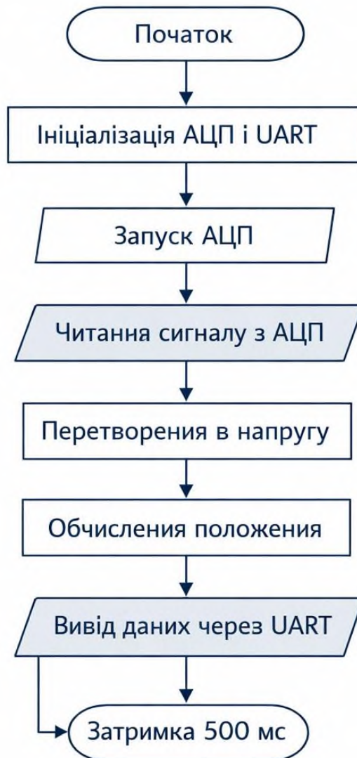
Рисунок 3.6 – Блок-схема зчитування даних з індуктивного давача переміщення
