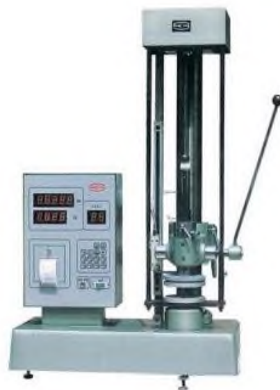
Рисунок 1.4 – Апарат TLS-S-1, призначений для тестування пружних елементів.
