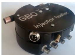
Рисунок 3.4 - Стенд діагностики газових форсунок + осцилограф
