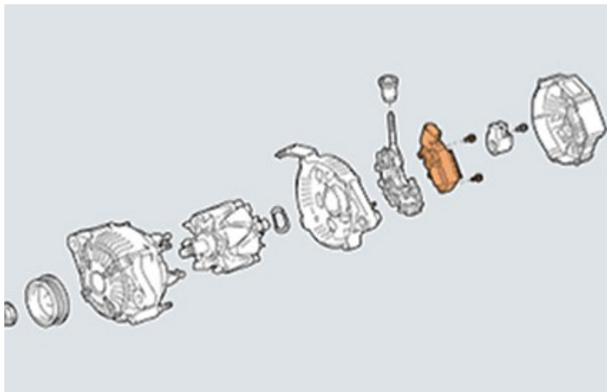
Рисунок 2.14 – Зняття регулятора напруги в зборі [14]
