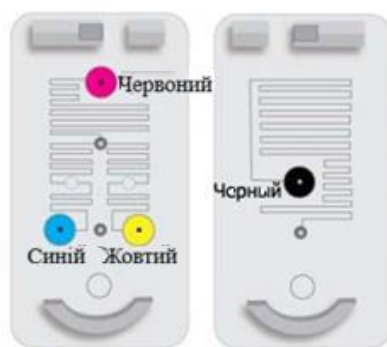
Рисунок 2.22 – Розміщення кольорів в картриджах Canon
