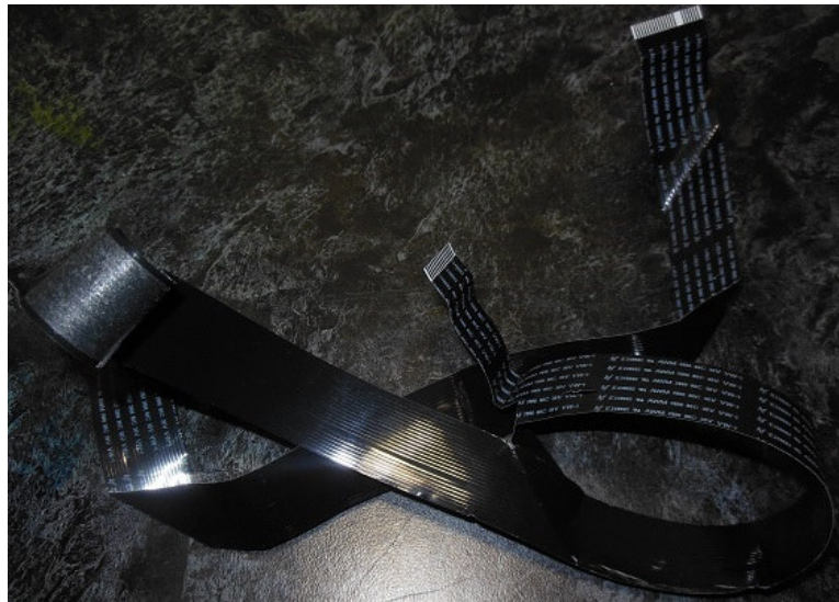
Рисунок 2.29 – Установка нового шлейфа сканера
