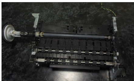
Рисунок 2.15 – Заміна шестерні вузла перемикування
