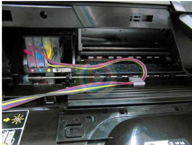
Рисунок 2.19 – Фіксація шлейфу СНПЧ.
