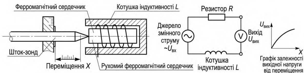
Рисунок. 2.8 - Принципова схема індуктивного перетворювача
