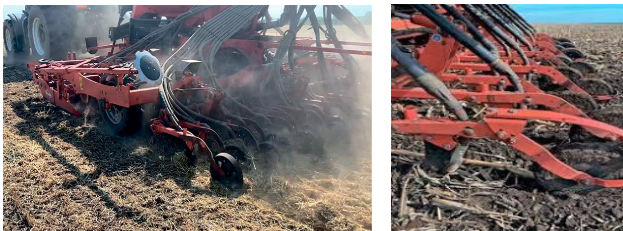
Рисунок 1.2 – Втискування соломи у насінневу борозну дисковим сошником
