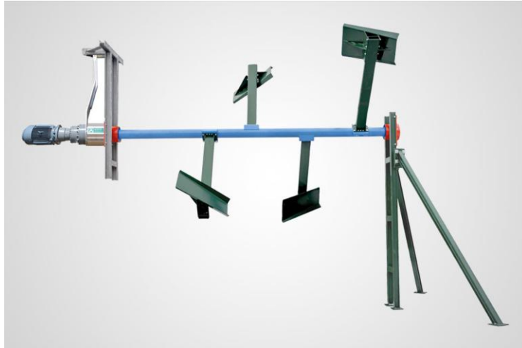
Рисунок 1.8 – Горизонтальний консольний лопатевий мішалковий агрегат для ферментера циліндричної форми
