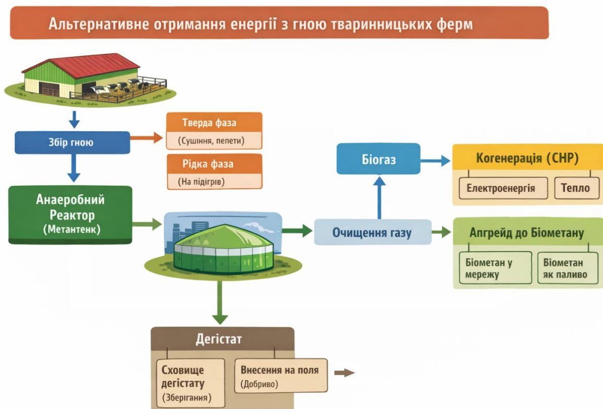
Рисунок 1.4 – Технологічна схема отримання альтернативного джерела енергії з гною
