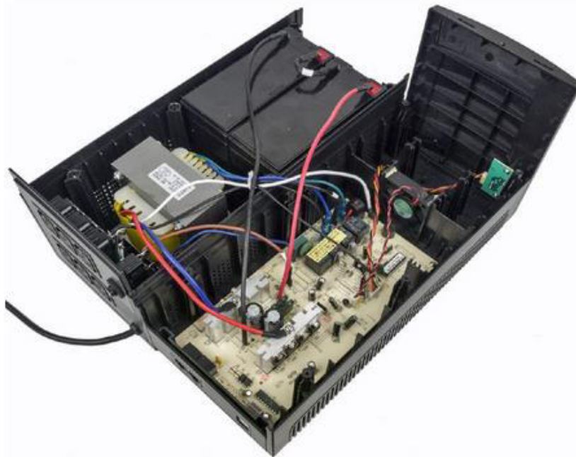
Рисунок 2.3 – Внутрішня будова Powercom RPT-1025AP
