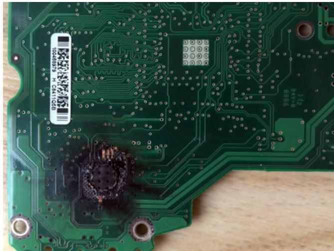
Рисунок 2.16 - Несправність інтегральної схеми попереднього підсилення та комутації.
