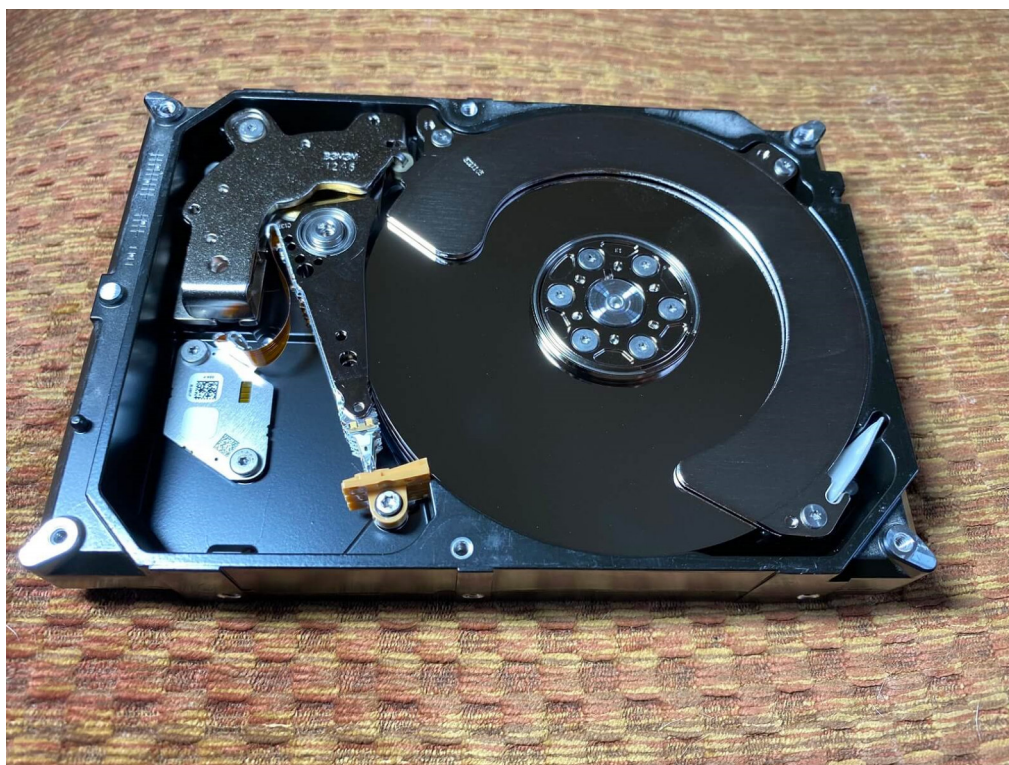
Рисунок 1.9 – Внутрішня структура герметичного блоку
