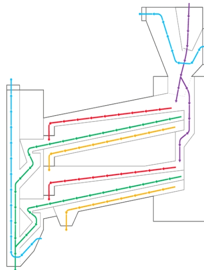
Рисунок 3.8 – Схема руху зерна і домішок у системі очищення У13-СПВ
