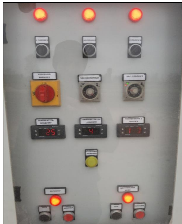
Рисунок 3.9 – Пульт керування зерносушарки Zafrani 210
