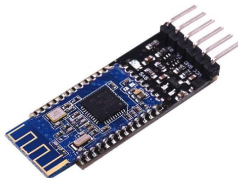
Рисунок 2.4 – Модуль Bluetooth HM-10
