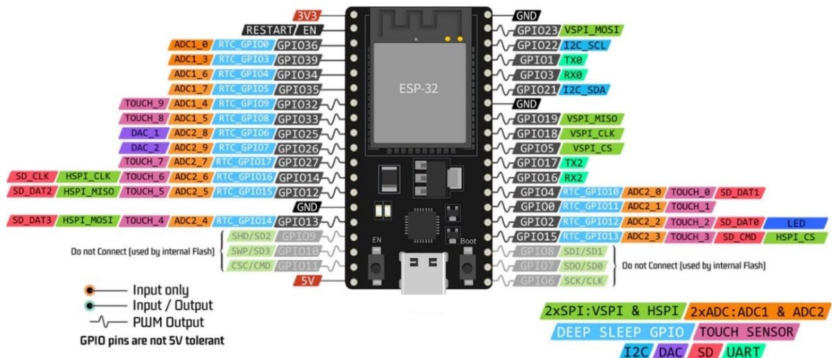
Рисунок 2.2 – Розпіновка плати розробника на базі мікроконтролера ESP32
