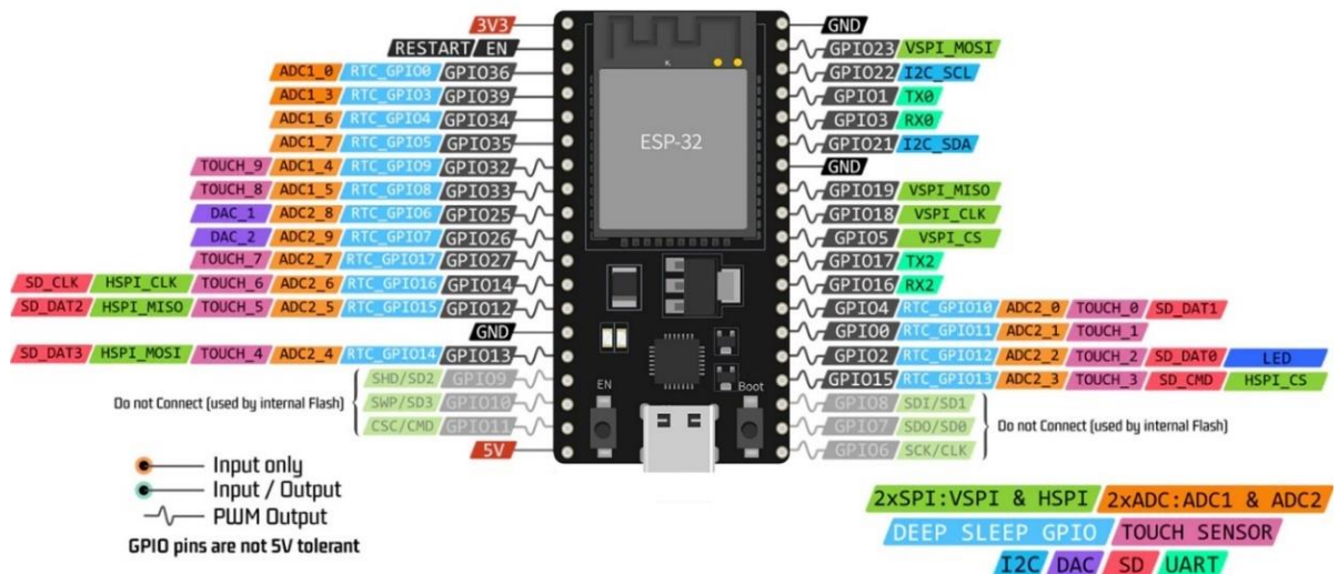
Рисунок 2.2 – Розпіновка плати розробника на базі мікроконтролера ESP32
