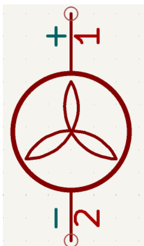
Рисунок 2.16 - Умовне позначення вентилятора
