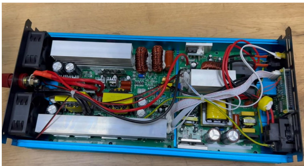
Рисунок 1.7 – Внутрішній вигляд перетворювача
