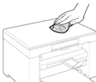
Рисунок 2.9 – Очищення корпусу пристрою
