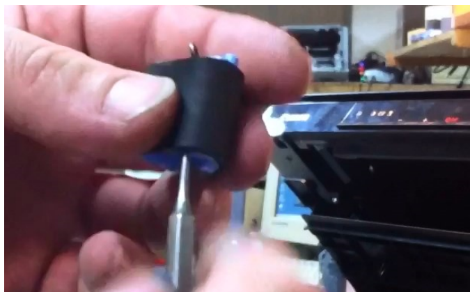
Рисунок 2.27 – Заміна захватної гумки ролика подачі паперу
