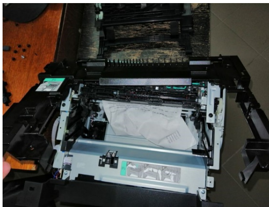
Рисунок 2.33 – Демонтаж верхньої кришки БФП
