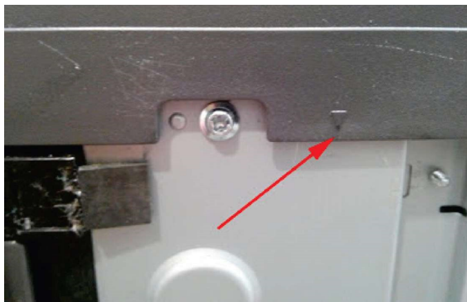
Рисунок 2.18 – Від'єднання засувки знизу
