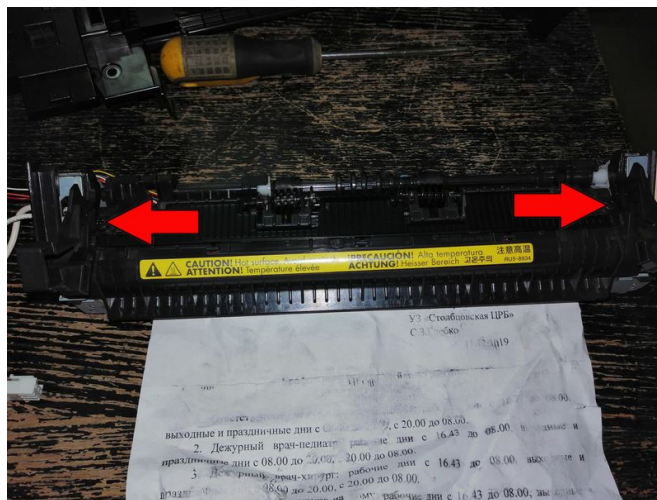
Рисунок 2.36 – Розбирання вузла пічки
