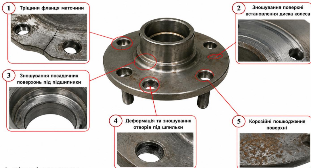
Рисунок 1.3 – Характерні дефекти маточини переднього колеса
