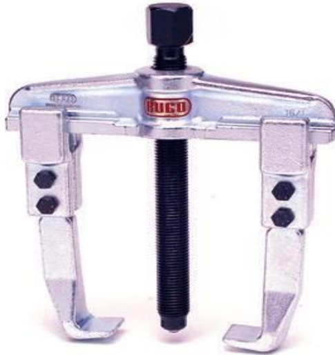
Рисунок 1.4 – Механічний двозахоплюючий знімач BUCO 16/1
