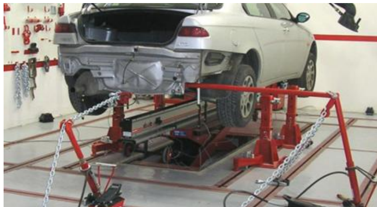
Рисунок 1.6 – Стапель для відновлення геометрії кузова автомобіля
