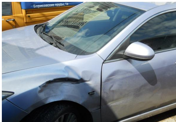
Рисунок 1.3 – Механічне пошкодження крила легкового автомобіля
