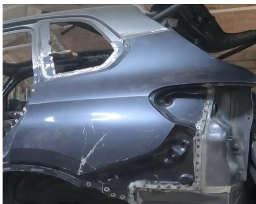
Рисунок 1.7 – Приварювання ремонтної вставки до кузовної панелі автомобіля
