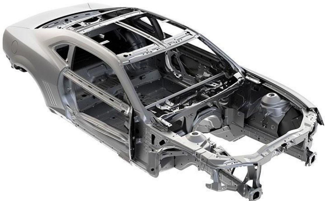
Рисунок 1.1 - Несучий кузов легкового автомобіля
