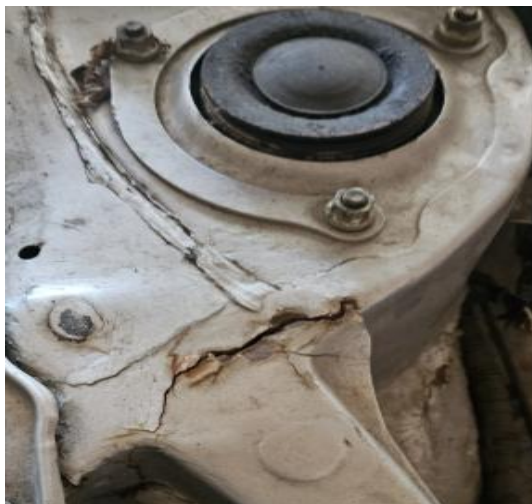
Рисунок 1.4 – Втомне руйнування кузовної частини автомобіля
