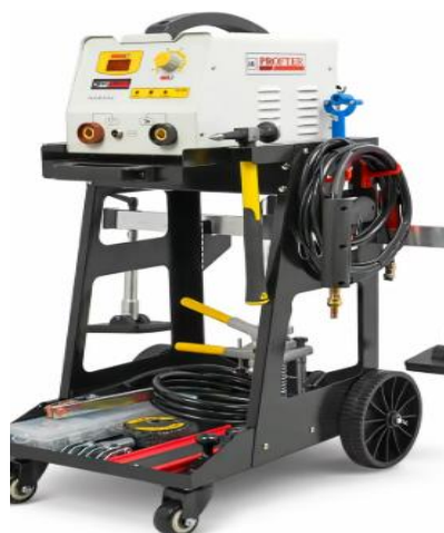
Рисунок 1.5 – Обладнання для рихтування та витягування кузовних деталей автомобіля
