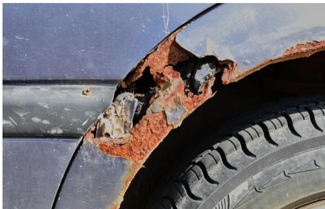
Рисунок 1.2 – Корозійне пошкодження задньої арки легкового автомобіля
