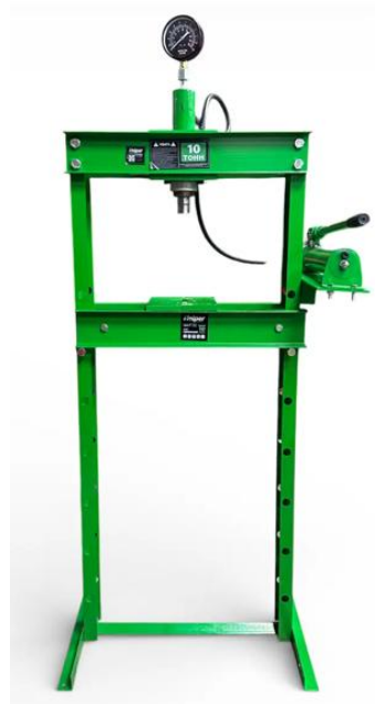
Рисунок 3.1 – Загальний вигляд гідравлічного ручного пресу Werther International PR10PM
