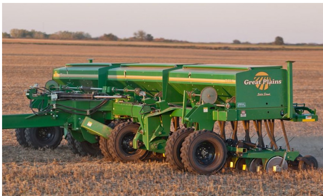
Рисунок 1.3 – Пневматична зернова сівалка Great Plains 3S-3000F
