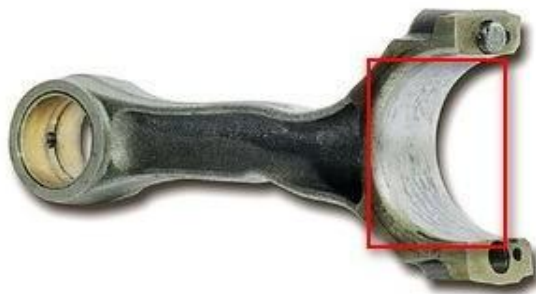
Рисунок 1.20 - задираки на робочій поверхні нижній головки шатуна
