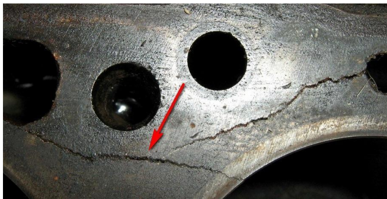
Рисунок 1.15 - Тріщина блока циліндрів
