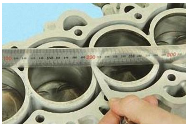
Рисунок 2.7 – Контроль привалкової площини блока циліндрів після відновлення
