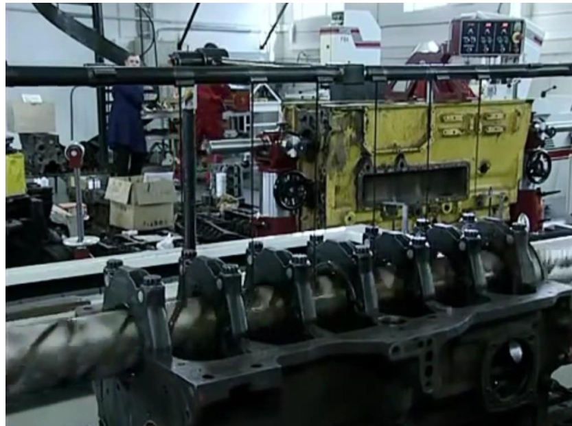
Рисунок 2.14 – Розточування та хонінгування ліжок колінчастого та розподільного валів
