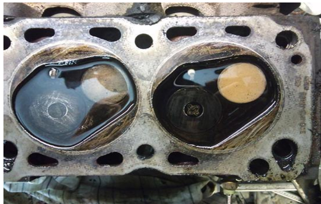
Рисунок 2.4 – Перевірка герметичності клапанів після відновлення
