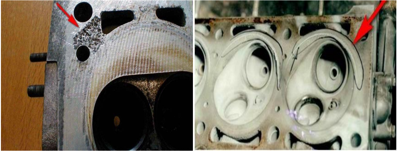
Рисунок 1.1 - Дефекти привалкової площині головки блоку циліндрів а, б – корозія привалкової площини; в – прогари валкової площини
