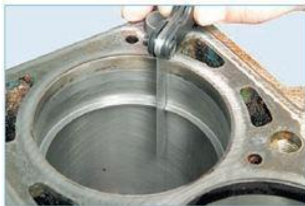
Рисунок 2.22 – Перевірка зазору в замку поршневого кільця
