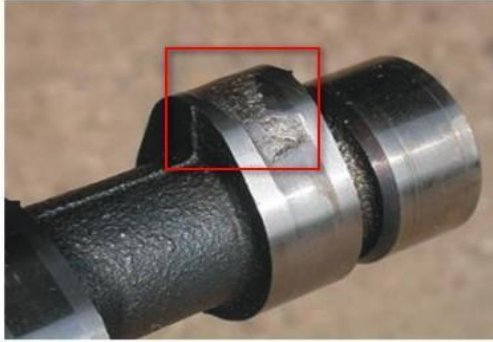
Рисунок 1.10 - Задири на робочій поверхні кулачків
