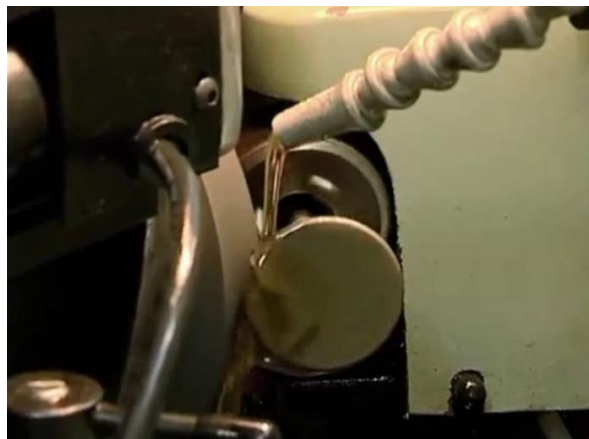
Рисунок 2.11 – Механічна обробка клапана та сідла клапана
