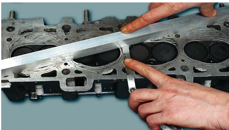
Рисунок 2.2 – Перевірка деформації привалкової площини головки блока циліндрів
