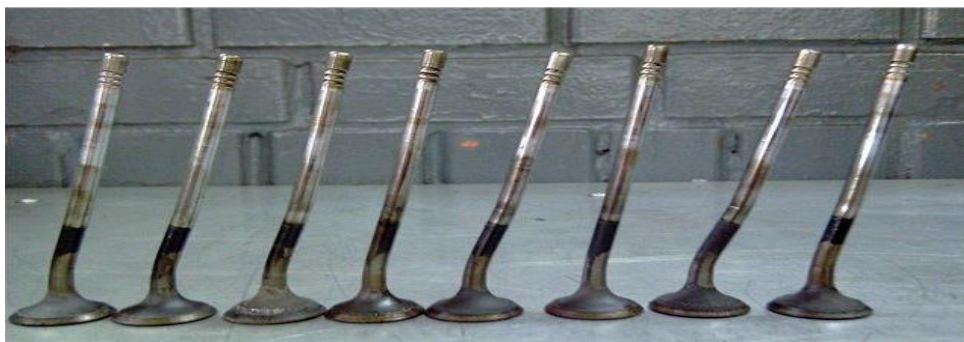
Рисунок 1.6 – Вигин стрижня клапана
