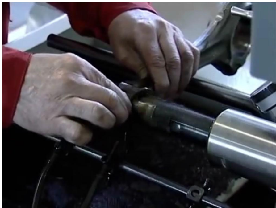
Рисунок 2.18 – Хонінгування нижньої головки шатуна
