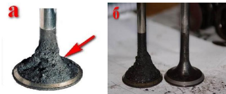
а - нагар на тарілці клапана; б - клапан з нагаром і без нагару
