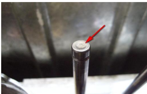
Рисунок 1.7 - Деформація торця клапана
