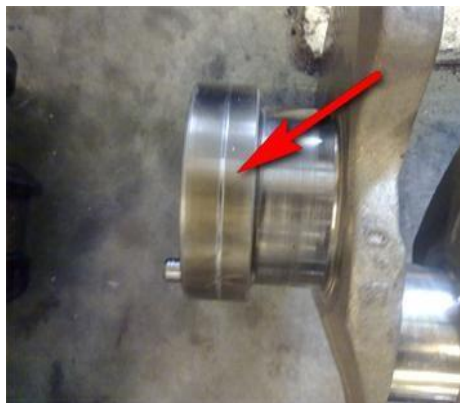
Рисунок 1.25 - Вироблення поверхні під сальники
