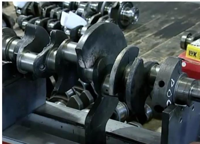
Рисунок 2.15 – Виправлення колінчастого вала
