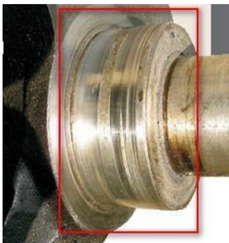
Рисунок 1.23 - Зношування торцевий поверхні колінчастого вала
