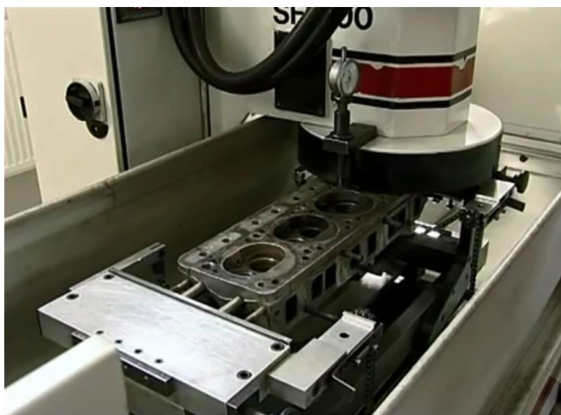
Рисунок 2.12 – Шліфування привалкової площини головки блока циліндрів
