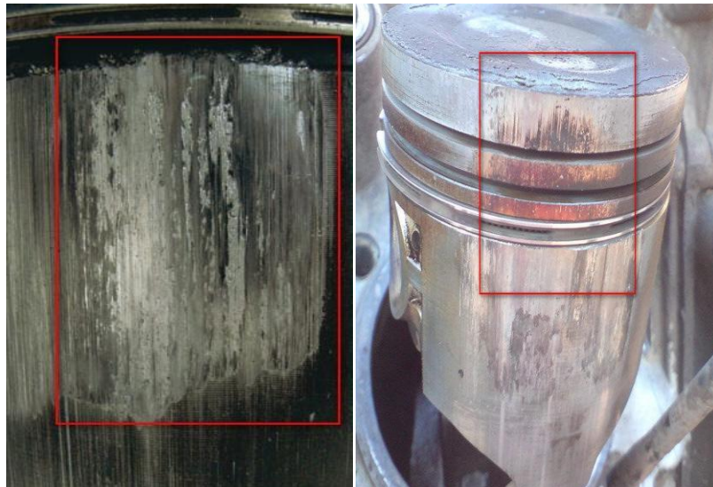
Рисунок 1.17 - Місцеві задираки на поршні
