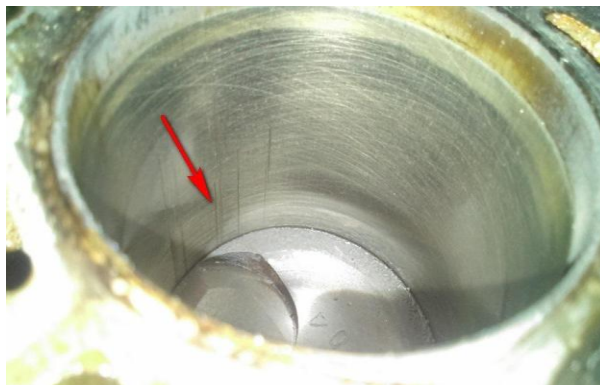
Рисунок 1.12 - Подряпини на поверхні циліндра
