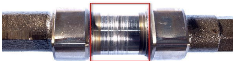
Рисунок 1.9 - Задири на опорній шийці розподільного вала
