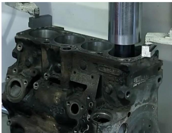
Рисунок 2.13 – Розточування та хонінгування блока циліндрів
