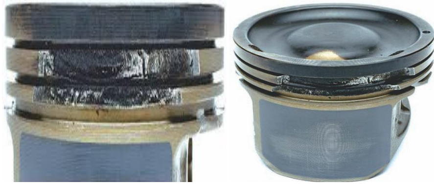
Рисунок 1.19 - Руйнування перемичок між канавками під поршневі кільця
