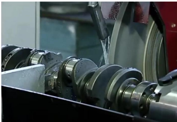
Рисунок 2.16 – Шліфування колінчастого вала
