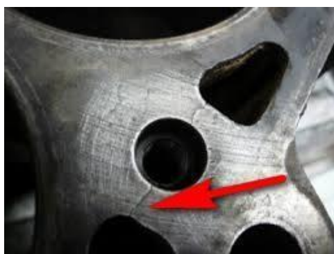
Рисунок 1.14 - Тріщини в районі отворів під болти
