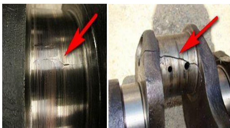
Рисунок 1.24 - Тріщини колінчастого вала
