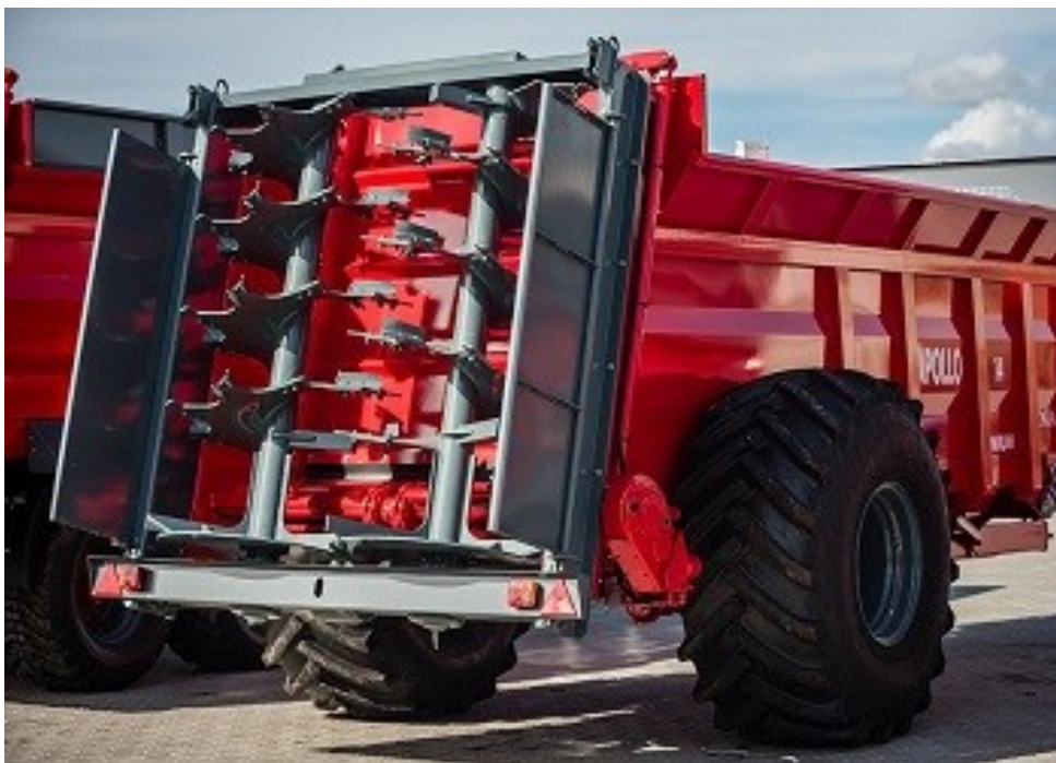
Рисунок 1.2 – Розкидач органічних добрив ТЕВВЕ MS 140 з вертикальними лопатевими валами
