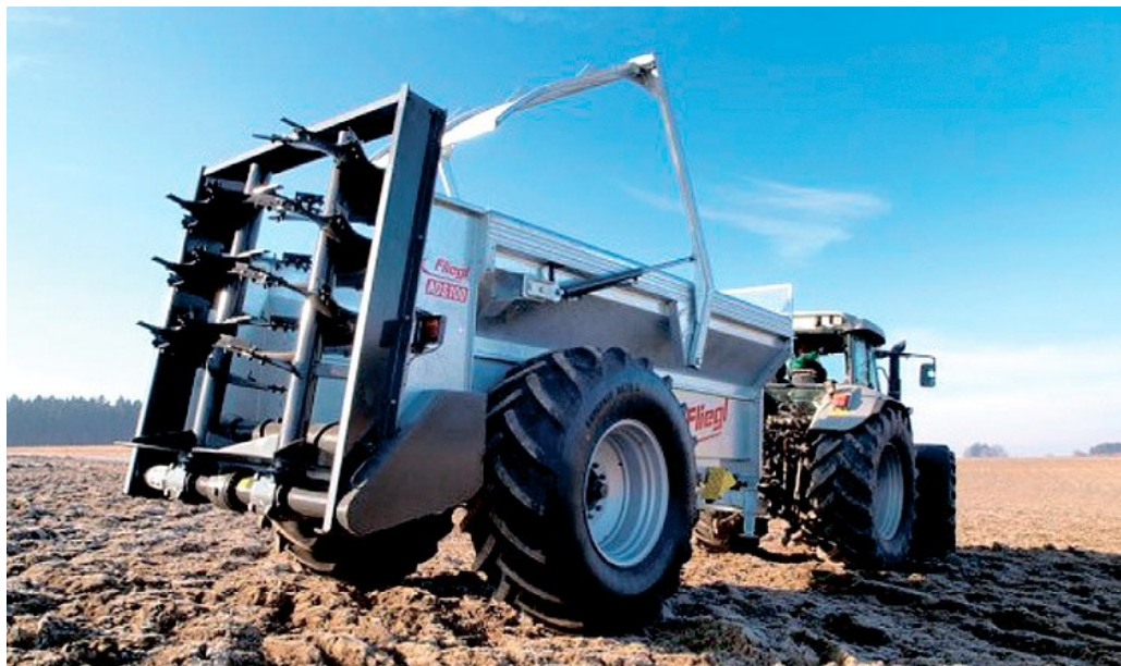
Рисунок 1.4 – Розкидач органічних добрив Fliegl ADS100 з механізмом подання добрив типу «рухома стінка»
