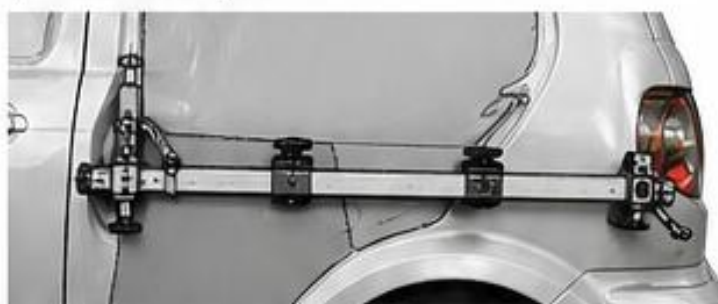
Рисунок 3.3 - Приклад застосування контрольного пристосування на автомобілі Daewoo Matiz
