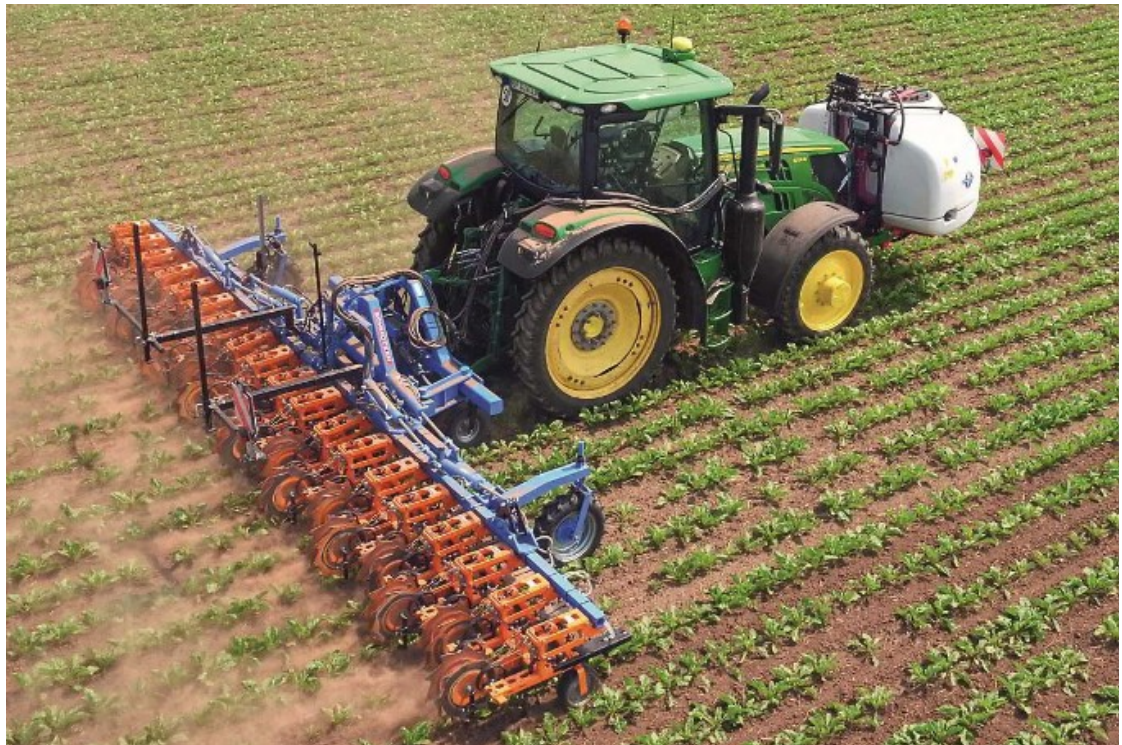
Рисунок 1.4 – Агрегат для механічного догляду за посівами компанії Schmotzer
