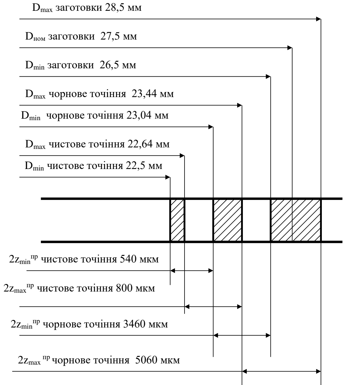
Рис. 2.8 - Схема графічного розміщення розмірів та припусків для обробки поверхні \varnothing 22,64 - 0,14 під різьбу M24x2 – 6q
