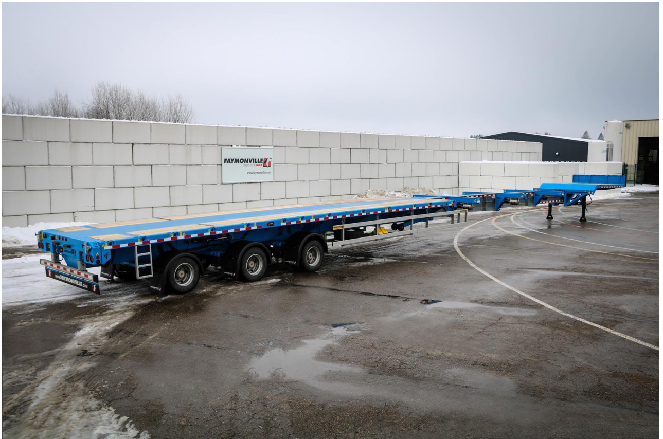
Рисунок 2.2 – Платформа Faymonville TeleMAX для перевезення лопаті вітрогенератора
