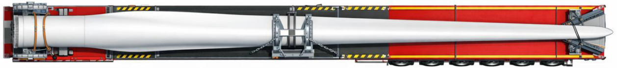
Рисунок 2.4 – Схема кріплення лопаті (вид зверху, умовно)
