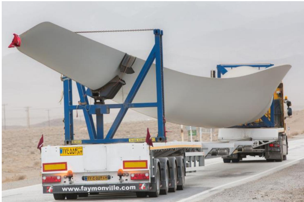
Рисунок 2.6 –Варіанти кріплення лопаті вітрогенератора Vestas V66 на платформі Faymonville TeleMAX:
