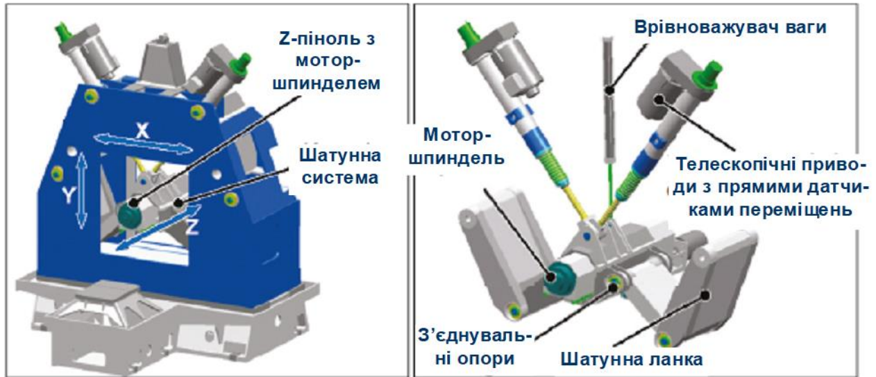
Рисунок 1.4 – Конструктивне виконання та принципова схема високошвидкісного обробного центра з паралельною кінематикою типу «біпод» з шатунними ланками
