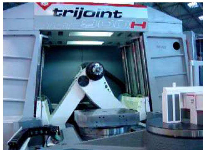
Рисунок 1.6 – Концепція обробного центра типу «біглайд» мод. TriJoint 900H фірми Kovosvit (Чехія)
